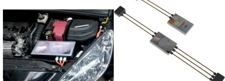
Boîtiers de simulation de véhicule électrique pour les formations à l'habilitation électrique B0L, B1VL, B2VL, BCL, conformément aux compétences du nouveau référentiel de formation de « maintenance des véhicules ».
