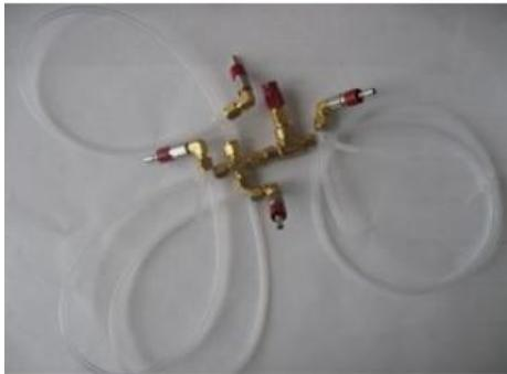
**Flexible d'alimentation hydrogène 15 bar pour 3 réservoirs hydrure vers pile Nexa 1200 OEM**
