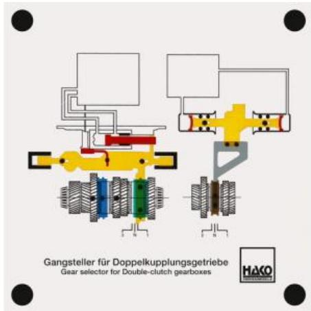
Dans la boîte de vitesses directe, l'actionnement des fourchettes de commande est hydraulique et non par des tringles de commande comme dans la boîte de vitesses traditionnelle.
