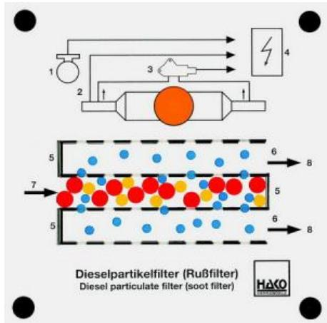
Le filtre à particules se compose d'un corps céramique en forme de nid d'abeille. Il est divisé en une multitude de petits canaux parallèles disposés en alternance. Les gaz suivants sont contenus dans les gaz d'échappement : Monoxyde de carbone, dioxyde de carbone, oxydes d'azote, hydrocarbures, dioxyde de soufre (tous représentés en bleu). En outre, des particules de suie (en rouge) et un additif (en jaune).
