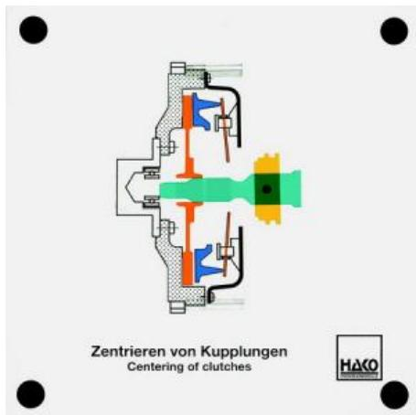
Lors du remplacement du disque d'entraînement, celui-ci doit impérativement être centré dans le volant d'inertie.
