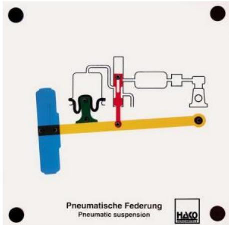
Régulation du niveau : lorsque le véhicule est en charge, le régulateur de niveau s'ouvre dans la vanne de régulation et de l'air s'engouffre dans le soufflet de la suspension pneumatique jusqu'à ce que le niveau normal soit à nouveau atteint.
