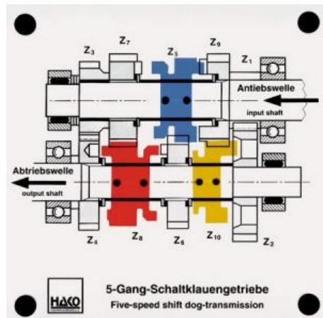
Flux de force dans le mécanisme de changement de vitesse à crabots.
