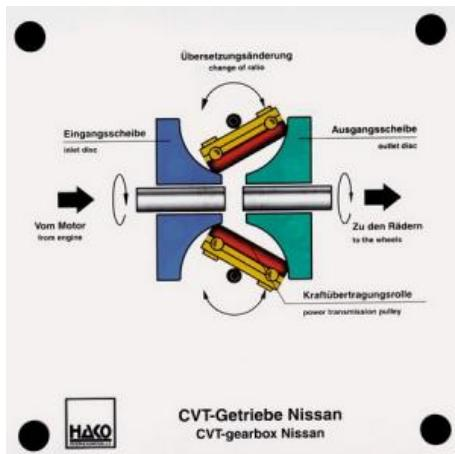
Transmission à variation continue pour véhicules à traction arrière, convient jusqu'à 500 Nm.
