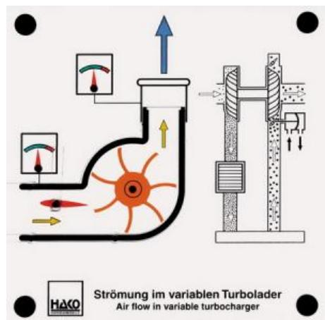
À l'aide de la soufflante fournie, de l'air est injecté dans le turbocompresseur. Fonction des aubes directrices : lorsque le moteur tourne à bas régime, la section transversale se rétrécit et la roue de la turbine tourne plus vite.
