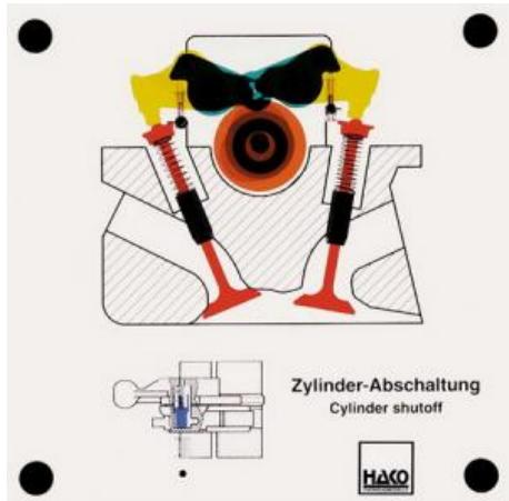
La désactivation des cylindres développée pour la nouvelle Classe S de Mercedes-Benz est activée et désactivée de manière électrohydraulique par l'appareil de commande.
