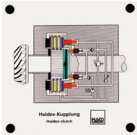
Il remplace le visco-coupleur sur les quatre roues motrices.
