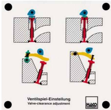
Il est possible de montrer 4 façons différentes de régler le jeu des soupapes.
