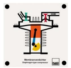
Maquette transparente: Compresseur à membrane
