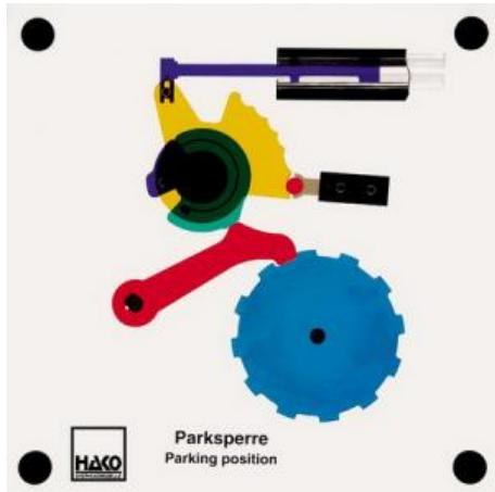
Si le levier sélecteur est en position "P" sur les boîtes de vitesses automatiques, le blocage de stationnement est enclenché et empêche le véhicule de rouler.
