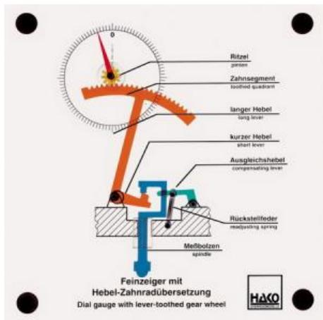
La fonction et les mouvements internes de l'aiguille de précision peuvent être démontrés de manière impressionnante.
