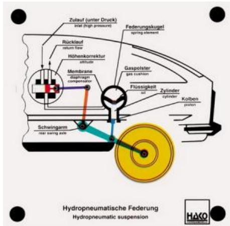
La membrane de la bille de suspension et le piston sont déplacés par la compression et la détente de la roue. En même temps, la soupape de la correction de hauteur (arrivée ou retour) est actionnée.
