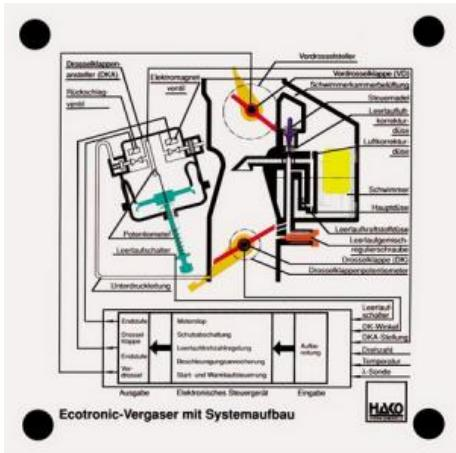
Réglable : flotteur et vis de ralenti, régulateur de pré-régime, aiguille de commande, clapet de pré-régime, papillon des gaz et potentiomètre du papillon des gaz.
