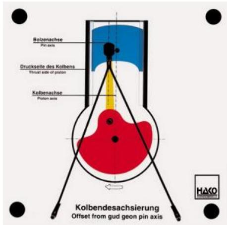
Sans désaxage : le piston change de côté d'attaque après le PMH. (sous pleine pression de combustion).
