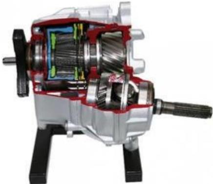
Cette boîte de transfert est utilisée sur les véhicules Mercedes Benz 4 Matic avec transmission automatique à convertisseur de couple.
