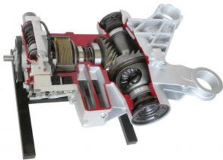
Tout peut être déplacé; la fonction de l'embrayage peut être bien démontrée en pressant les disques de friction ensemble.
