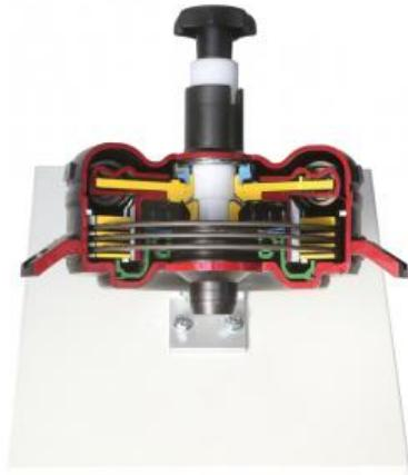
L'embrayage de démarrage humide est un embrayage à faible inertie rotative, ce qui rend la transmission automatique extrêmement spontanée et dynamique sans les pertes typiques des équipements de transmission de puissance.
