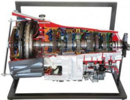
La 9G-Tronic est une toute nouvelle transmission automatique à commande électronique avec neuf vitesses avant et une marche arrière.
