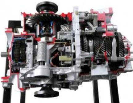
**Boîte à 7 vitesses automatiques à double embrayage en coupe, Mercedes-Benz SLS AMG**
