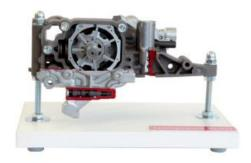
Les nouveaux moteurs à 6 et 8 cylindres en V de Mercedes Benz utilisent une pompe à huile à palettes nouvellement mise au point avec une régulation de la quantité en fonction de la demande et deux niveaux de pression contrôlés par carte.
