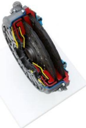
Les disques débrayage, les rondelles Belleville et les plaques de pression sont faciles à voir.
