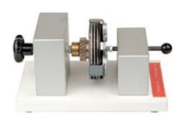
Le type d'embrayage est principalement utilisé dans les véhicules à deux roues.
