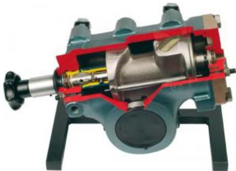
Lorsque la broche de direction est tournée à l'aide du bouton en croix, le piston de l'écrou de direction est déplacé dans le cylindre du boîtier.
