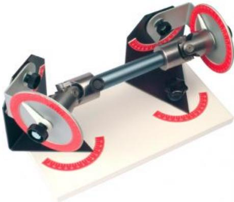
Si les joints universels sont entraînés sans plier une partie de l'arbre, ils fonctionnent avec un mouvement de rotation constant.
