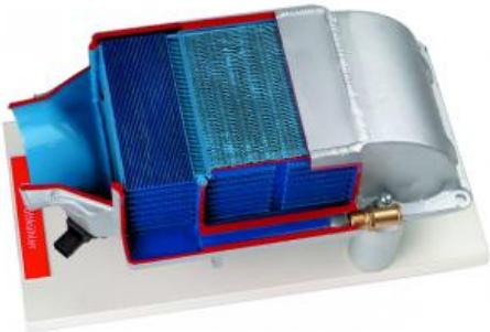
Ce refroidisseur d'air de suralimentation est un échangeur thermique air-eau avec un circuit de refroidissement séparé.
