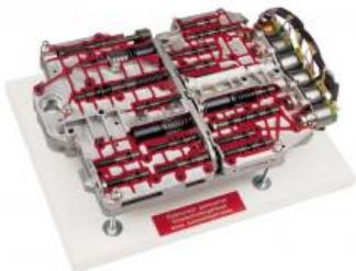
Ce modèle donne un aperçu de l'intérieur complexe d'un boîtier hydraulique à tiroir moderne. Le boîtier ouvert montre les pistons de commande et les ressorts de commande. Une électrovanne électrique a également été ouverte pour étudier son intérieur.
