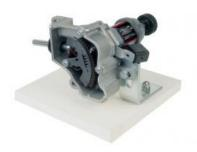
Un moteur électrique entraîne un segment d'une roue à vis sans fin via une vis sans fin.
