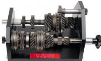
Conception d'une transmission à deux arbres pour véhicules à traction avant.
