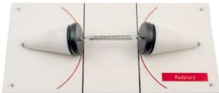
Une roue inclinée ne roule pas sur une trajectoire droite, mais sur une trajectoire circulaire. Si l'on pousse les roues vers l'avant, elles tendent à s'écartier à l'avant en raison du cône de roulement. Grâce à une sélection précise de la voie, la roue roule en ligne droite et le flottement des roues est évité.
