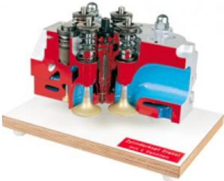
Cette lourde culasse à injection directe à quatre soupapes Daimler-Benz est en fonte grise. Les soupapes peuvent être actionnées facilement en installant des ressorts plus minces. Au milieu de la tête se trouve la buse d'injection découpée. De plus, il y a une vanne de décompression entre les soupapes.
