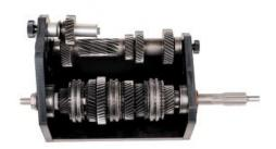
Fonctionnement de l'arbre de transmission, de l'arbre principal, de l'arbre secondaire et du pignon de marche arrière. Construction d'une boîte de vitesses à 5 rapports.
