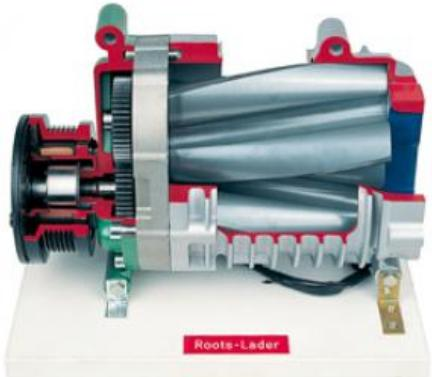
Ce compresseur mécanique est installé dans les voitures de sport à compresseur Daimler-Benz. Les deux rotors ont chacun trois pales et sont entraînés par des engrenages. L'aspiration et la compression peuvent être visualisées.
