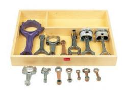
2 bielles avec pistons et axes de piston. Bielles divisées et non divisées. Bielles en acier et en aluminium. Bielle avec grosse extrémité droite et déportée divisée. Bielle avec extrémité large lisse, dentée, goupillée et cassée.
