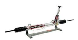
Séquence de mouvement dans l'appareil à gouverner, rapport de transmission dans le système de direction. Fonction de la pièce de poussée et du piston de travail.
