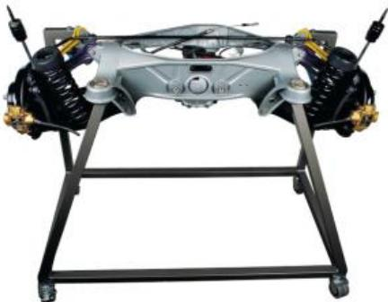
**Essieu à bras oscillant Mercedes-Benz avec différentiel en coupe**
