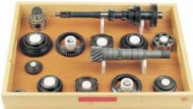
Boîte de vitesses à quatre vitesses avec arbre d'entrée et arbre de sortie pour traction avant (boîte de vitesses à axe inégal)
