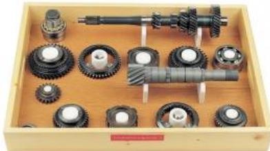
Boîte de vitesses à quatre vitesses avec arbre d'entrée et arbre de sortie pour traction avant (boîte de vitesses à axe inégal)
