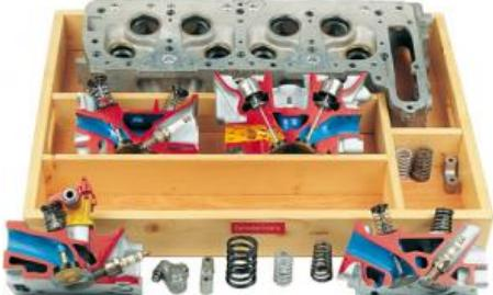
Modèle en coupe d'une culasse à 2 soupapes en séquence avec 2 culbuteurs.
