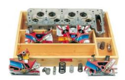
Modèle en coupe d'une culasse à 2 soupapes en séquence avec 2 culbuteurs. modèle en coupe d'une culasse à 2 soupapes (disposition transversale) modèle en coupe d'une culasse à 3 et 4 soupapes culasse entière sans soupapes roulement d'arbre à cames et divers ressorts de soupape
