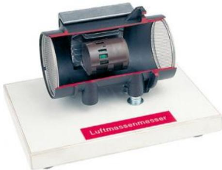
À l'intérieur du boîtier en plastique découpé, le filament de chauffage en platine, la résistance de précision et la résistance de compensation de température sont visibles dans le tube intérieur.
