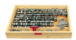
Arbres à cames assemblés, forgés et coulés. Arbres à cames pour moteurs 4-, 5-, 6 cylindres. Arbres à cames pour moteurs à quatre soupapes. Arbres à cames pour moteurs plats. Cames coupées. Différents paliers d'arbre à cames.
