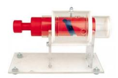
Fonctions d'un poussoir de pompe à tiroir : Remplissage de la chambre haute pression Début de l'injection, refoulement, fin de l'injection Régulation du débit par rotation du piston Réglage du début d'injection à l'aide du poussoir mobile
