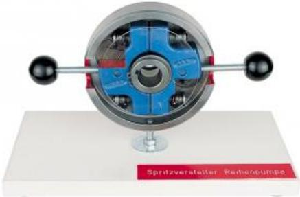
En tirant sur les boutons, les masselottes sont tirées vers l'extérieur à l'encontre de la force du ressort et règlent la sortie par l'intermédiaire d'excentriques dans le sens de "l'injection antérieure".
