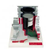
Le bloc-cylindres a été découpé de manière à ce que les chemises humides soient bien visibles. Les canaux de refroidissement (peints en bleu foncé) et l'étanchéité des chemises sont bien visibles.
