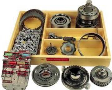
Contient les composants de transmission automatique les plus importants (certaines pièces sont en coupes). Commande hydraulique avec soupape de changement de vitesse, régulateur centrifuge, roue libre, pompe à engrenage interne, train épicycloïdal complet (facilement démontable), bande de frein, 2 raccords hydrauliques, position de stationnement avec cliquet, jeu de disques.
