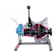
Structure de l'ensemble de la boîte de vitesses. Largement découpée à l'avant, en haut et à l'arrière.
