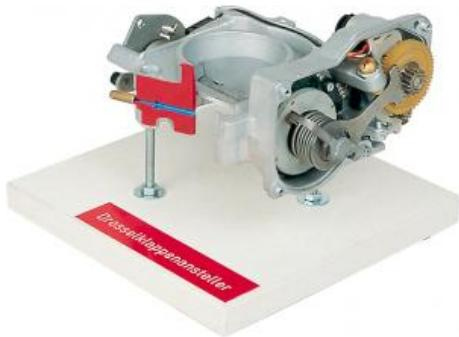
Levage des gaz via un moteur électrique contrôlé et pignons avec crémaillère
