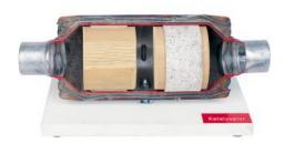
Boîtier métallique d'un nouveau convertisseur catalytique découpé pour montrer les deux corps en céramique. De plus, un nid d'abeilles coupé ouvre le tube à l'intérieur du boîtier en céramique.
